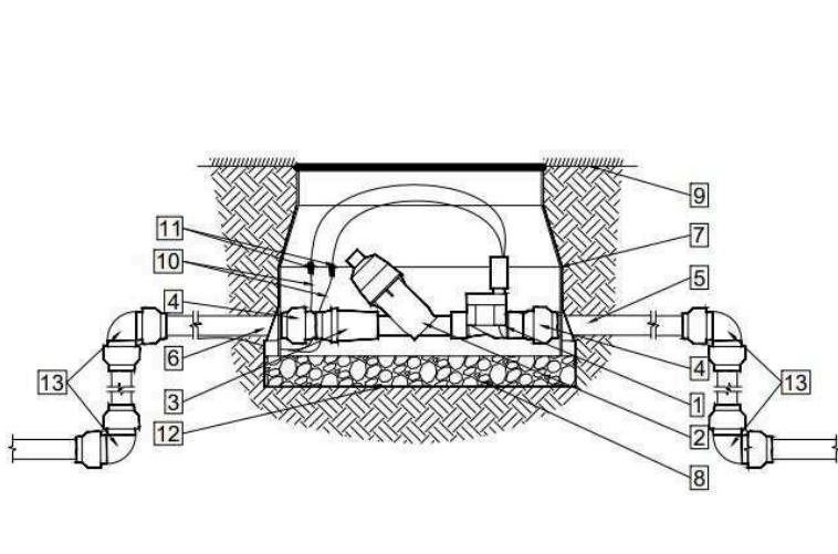
Рисунок Б3. Монтажный узел микроорошения
