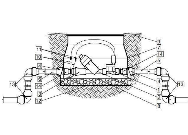
Рисунок Б4. Монтажный узел микроорошения на разъемных муфтах
